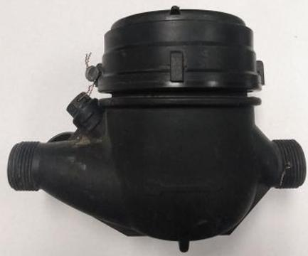
Asiento de Cuerpo con imperfecciones (mala calidad del fresado, producto de su uso excesivo), provoca la desalineación entre conjunto de turbina y relojería
