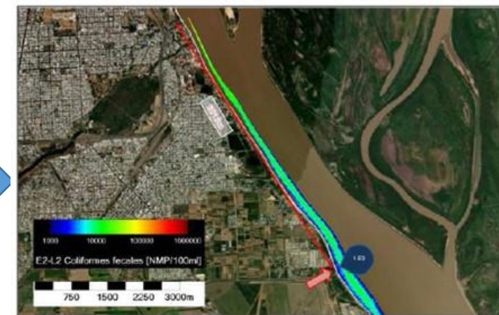
Figura 3 - Modelación Ambiental de la pluma para E2 y T90 = 3 días (fuente: Ingeniería Activa - ASSA)
