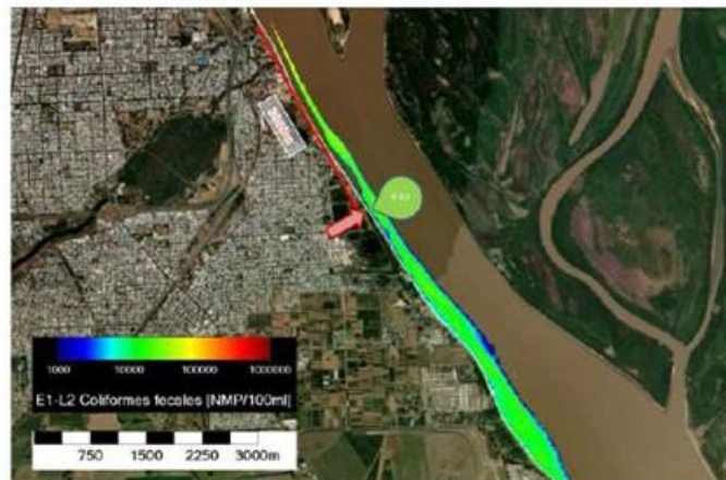
Figura 2 - Modelación Ambiental de la pluma para E1 y T90 = 3 días (fuente: Ingeniería Activa - ASSA)
