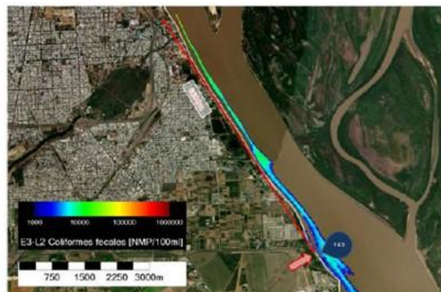
Figura 4 - Modelación Ambiental de la pluma para E3 y T90 = 3 días (fuente: Ingeniería Activa - ASSA)
